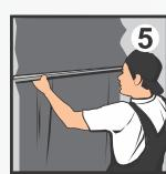
Нанесите штукатурку мастерком или шпателем. Толщина 1 слоя не должна превышать 6 см. После нанесения стену выровняйте полутерком или правилом за 2-3 прохода. При выравнивании смесь не следует вдавливать, так как уменьшается количество воздушных пор, штукатурка становится тяжёлой, начинает сползать и отваливаться.
