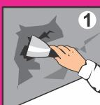
Основание должно быть чистым, прочным и иметь достаточную несущую способность. Удалите с него ослабляющие скрепление вещества: масляные и битумные пятна, пыль и прочие загрязнения. Отслаивающиеся участки удалите стальным шпателем. При необходимости, выровняйте основание штукатурными составами БОЛАРС.
