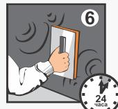
Затрите штукатурку, пока она находится во влажном состоянии, так как после высыхания при затирании разрушается структура теплоизолирующего слоя и повышается теплопроводность. Последующий слой штукатурки наносите не ранее, чем через сутки, при этом поверхность предыдущего слоя должна быть шероховатой. Перед нанесением клеевой или декоративной штукатурки необходимо на каждый 1 см нанесенного слоя теплоизоляционной штукатурки выдерживать 1 сутки для просушки.
